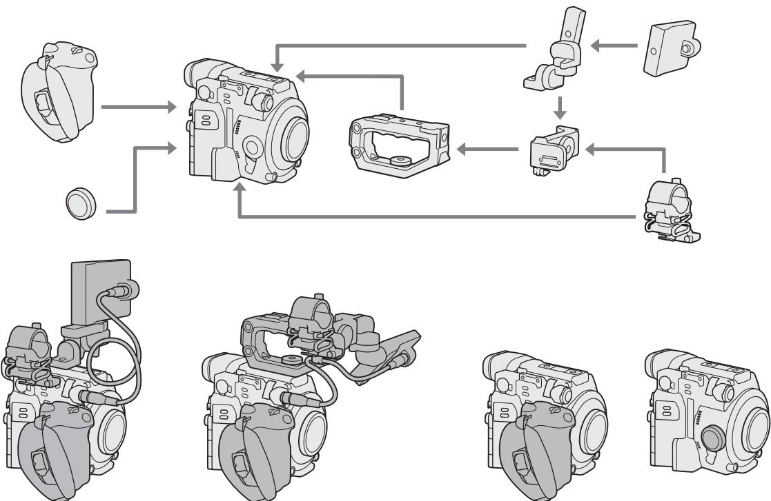
Конфигурация с ЖКД монитором и ручкой камеры
