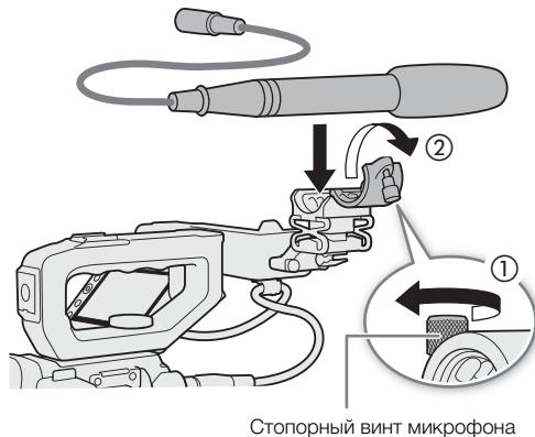
Стопорный винт микрофона
