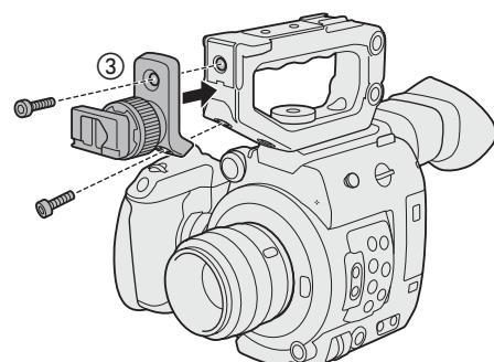
4 Установите на блок рукоятки дополнительно приобретаемое основание зажима CL-V2.
